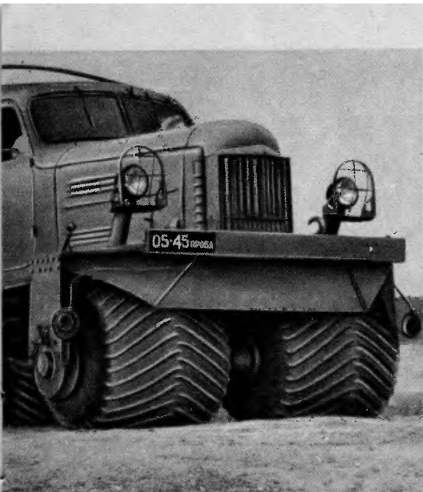
Рис. 7. Пневмокати-шины сверхнизкого давления.
