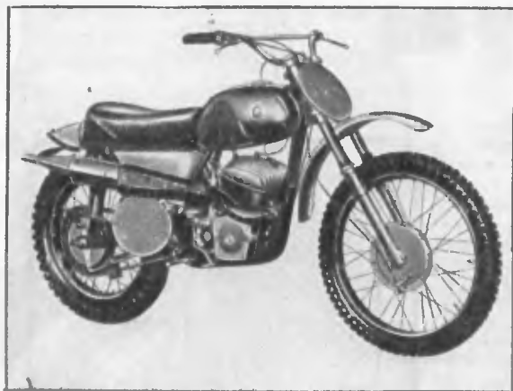
Мотоцикл «Чезет-969», на котором в 1967 году выиграно первенство мира в классе 500 см 3 . Двигатель рабочим объемом 362 см 3 (80×72 мм) или 392 см 3 (80×78 мм) развивает мощность 34 л. с. при 6000 об/мин. или 39 л. с. при 6800 об/мин. Вес 106 кг.
