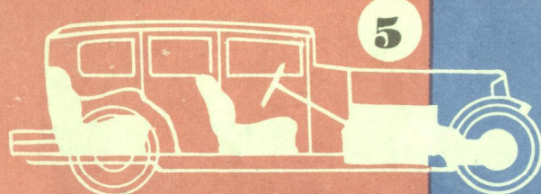
Рис. 4. Один из способов осуществить привод на передние колеса при зависимой подвеске [20-е годы].
