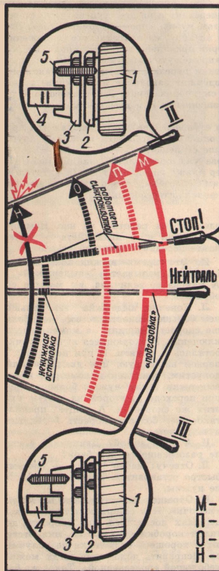
Рис. 1. Действия водителя при переходе с высших передач на низшие: М — мастерское переключение с двойным выжимом и «промежуточным газом». При идеальной «подгазовке» синхронизатору не нужно работать (маленькой ступеньки на рисунке не будет вовсе). Практически же он хоть незначительное время работает (отрезок на рисунке), поскольку в «подгазовке» бывает какая-то неточность; П — правильное переключение (полностью используем синхронизатор); О — ошибочное переключение с ненужной, вредной задержкой в нейтрале. Синхронизатору приходится дополнительно разогнать замедлившиеся детали «системы»; Н — недопустимо резкий перевод рычага («вбивание» передачи); 1 — шестерня второй передачи; 2 — зубчатый венец шестерни второй передачи; 3 — кольцо синхронизатора второй передачи; 4 — ползун; 5 — зуб скользящей муфты включения второй и третьей передач.
