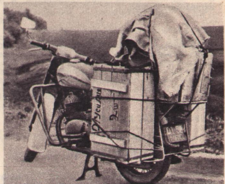
Так испытывался багажник с грузом 60 кг.
