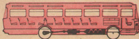
Компоновка городского автобуса с двигателем под полом.
