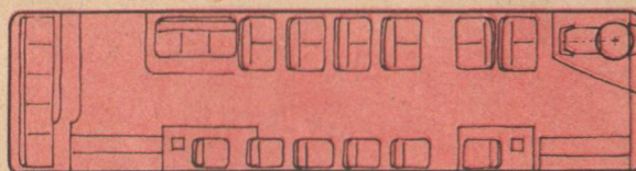
Сравнительная планировка автобусов городского (вверху) и междугородного (внизу) типов ЛАЗ-698 (26 мест для сидения и 44 места для стояния) и ЛАЗ-699А (41 место для сидения).
