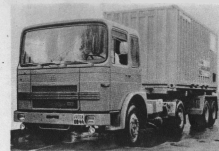
Тягач «Раба» с полуприцепом, на котором установлен морской контейнер.
