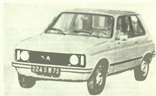
«Ситроен-ЛН»: оппозитный двухцилиндровый (602 см 3 , 32 л. с. при 5750 об/мин) двигатель от «Ситроена-диана», трансмиссия от «Ситроена-ЖС» с приводом на передние колеса и трехдверный кузов от «Пежо-104К» — вот из чего «приготовлена» новая модель. Длина этой типично городской машины — 3,38 м, масса в снаряженном состоянии — 706 кг, скорость — 120 км/час, время разгона с места до 100 км/час — 29,3 секунды.
