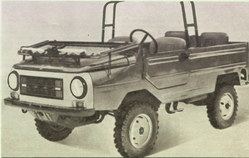
При сложенном тенте, снятых надставках дверей и откинутом на капот ветровом стекле необходимую безопасность в случае переворачивания автомобиля обеспечивает защитный трубчатый каркас дуг безопасности.
