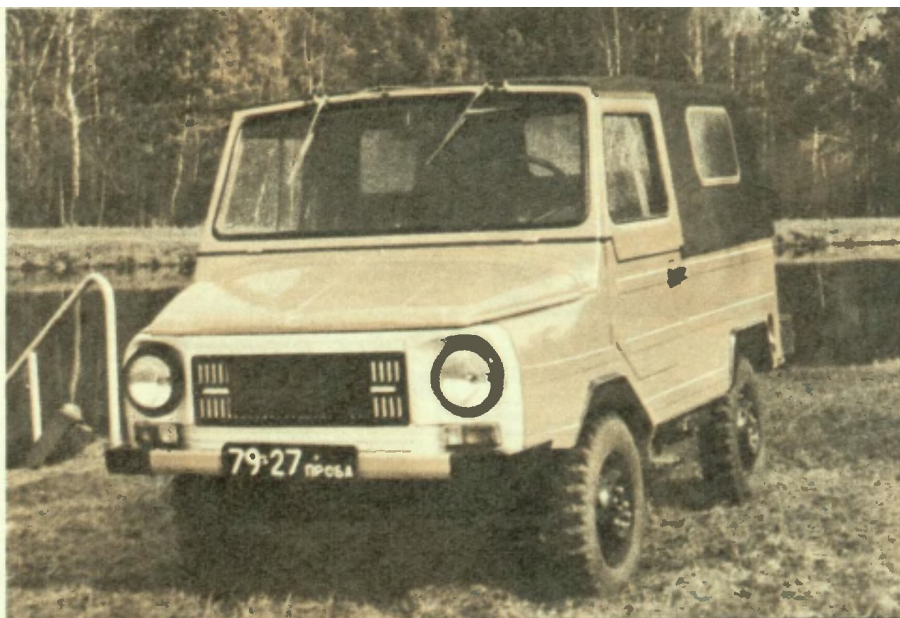
Новые фары и указатели поворота, элегантная передняя панель кузова, бамперы резко изменили внешний вид луцкого джипа.
