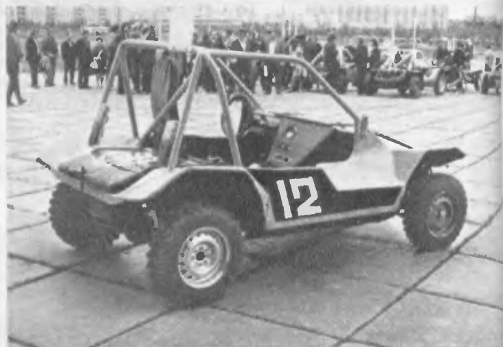
2. Багги, построенный спортсменами «АвтоВАЗтехобслуживания»: компоновка — классическая; двигатель ВАЗ; передняя подвеска — независимая; задний мост — ВАЗ; база — 2200 мм; колеса — 1350/1350 мм; масса — 450 кг.
