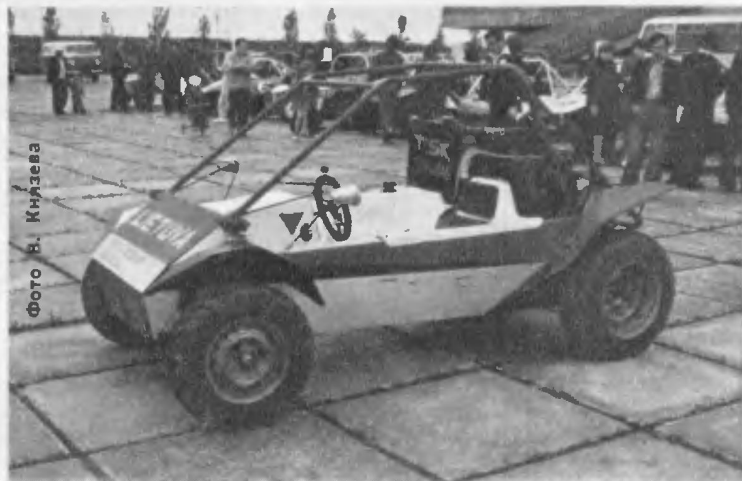
4. Багги, построенный Д. Пашкявичусом (СТК «Экранас», г. Паневежис): компоновка — двигатель в пределах базы; двигатель ГАЗ—24; подвеска всех колес — независимая; база — 2060 мм; колея — 1400/1400 мм; масса — 620 кг.
