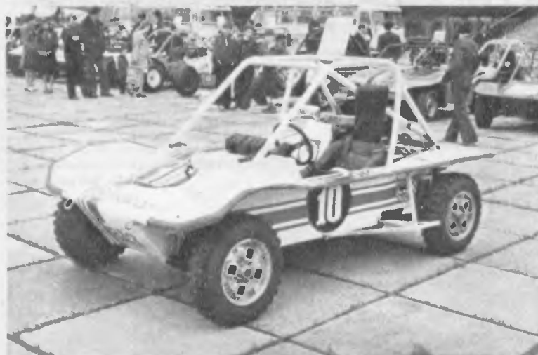
1. Багги, построенный на ВАЗе: компоновка — двигатель в пределах базы; двигатель ВАЗ; подвеска всех колес — независимая; масса — 600 кг.
