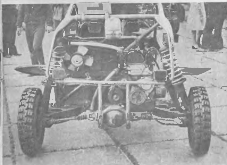
7. Багги конструкции КамАЗа. Видны редуктор ВАЗ, укрепленный на раме, и независимая подвеска задних колес на продольных штампованных рычагах.
