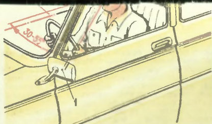
Рис. 2. Установка левого наружного зеркала: 1 — центр зеркала; 2 — точка глаз водителя; 3 — центр расстояния между глазами водителя; 4 — продольная ось автомобиля.
