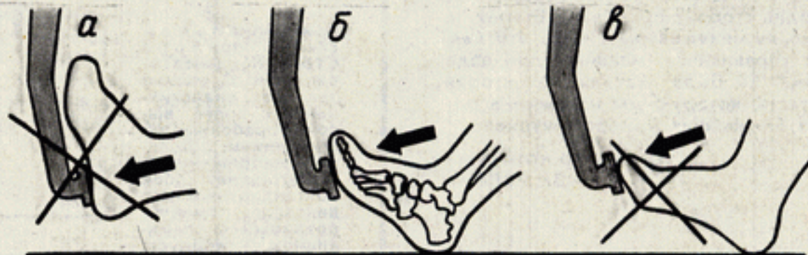
Рис. 4. Положение правой ступни на педали при торможении: а — действие пяткой; б — нажатие на педаль верхней частью стопы; в — пальцами.
