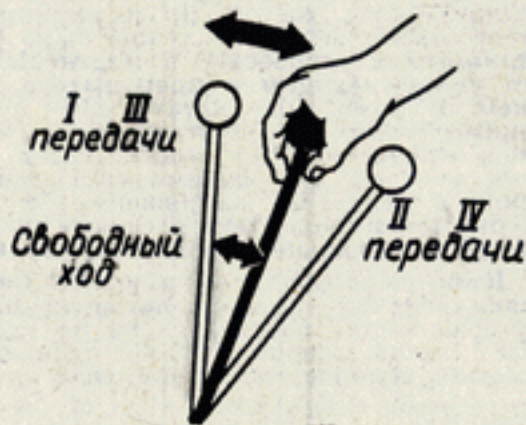
Рис. 2. Предварительный натяг для скоростного переключения передач при разгоне.
