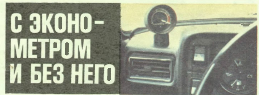
Так выглядит эконометр УРТЭ-1, установленный на приборной панели ВАЗ—2105.
