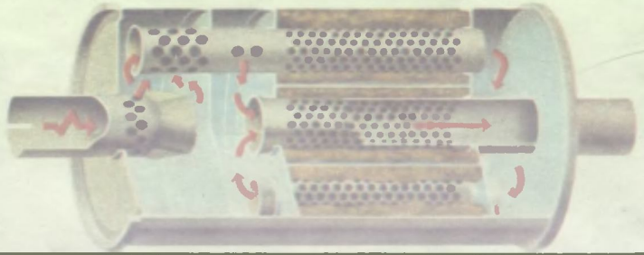
Рис. 3. Такой глушитель, сочетающий особенности активного и реактивного, работает в очень широкой полосе частот.
