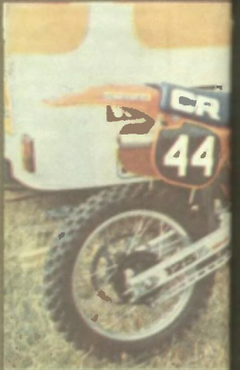
«Хонда-КР125» (Япония). Отлитый из легкого сплава. Под сиденьем виден амортизатор. Мощность — 30 л. с. при 10 500 об/мин. Ход колес: 290 и 310 мм. База — 1450 мм. Масса — 87,5 кг.
