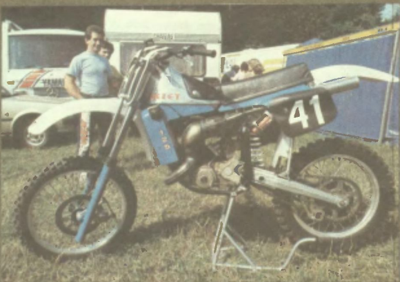
ЧЗ [ЧССР]. Картер двигателя — из магниевого сплава. Дисковый тормоз переднего колеса. Мощность — 33 л. с. при 11 400 об/мин. Ход колес: 300 и 340 мм. База — 1460 мм. Масса — 95 кг.
