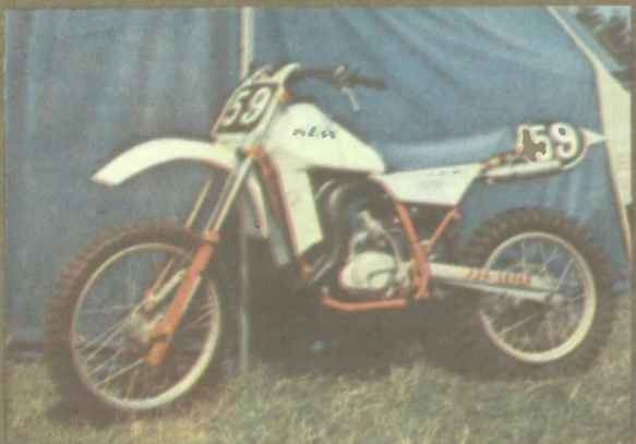
КТМ-МК-01 (Австрия). Блок лепестковых клапанов в картере двигателя. Подвеска заднего колеса «Про-Левел» с прогрессивной характеристикой. Мощность — 32 л. с. при 10 900 об/мин. Ход колес: 300 и 310 мм. База — 1470 мм. Масса — 95 кг.
